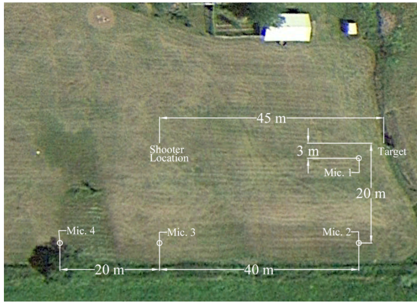
Figura A.2: Ubicaciones de los micrófonos, tirador y objetivo utilizados en la tarea Gunshot [283].
